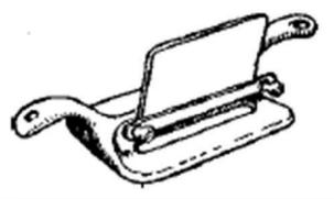
**Raspadeira americana** (fig. 7) - Instrumento de ferro fundido, onde se prende uma lâmina de aço para raspar madeiras.
