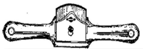
**Esgache** (fig. 9) - Instrumento de madeira, munido de dois parafusos de borboletas, que serve para retocar rebaxos ou fazer molduras.
