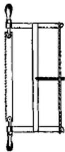
**Serra de traçar** (fig. 21) - Instrumento composto por uma lâmina larga de aço, dentada, presa numa armação de madeira constituída por uma haste (alfeizar), duas travessas (cabeceiras), dois “pernos” torneados, uma corda (cairo), que tem no centro um trabalho que a torce, ou uma haste de aço munida, numa das extremidades, de uma rosca e uma borboleta para esticar a serra. Serve para respigar e traçar em linha reta.
